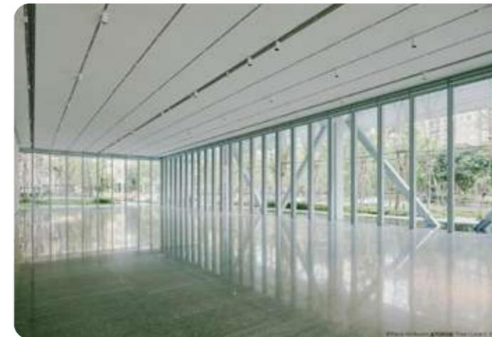
展廳採用玻璃帷幕設計，營造視覺穿透性與輕盈感，並選用具防火、耐候及環保特性的吸音塗料，提升降噪與吸音效果，有效減少環境干擾
