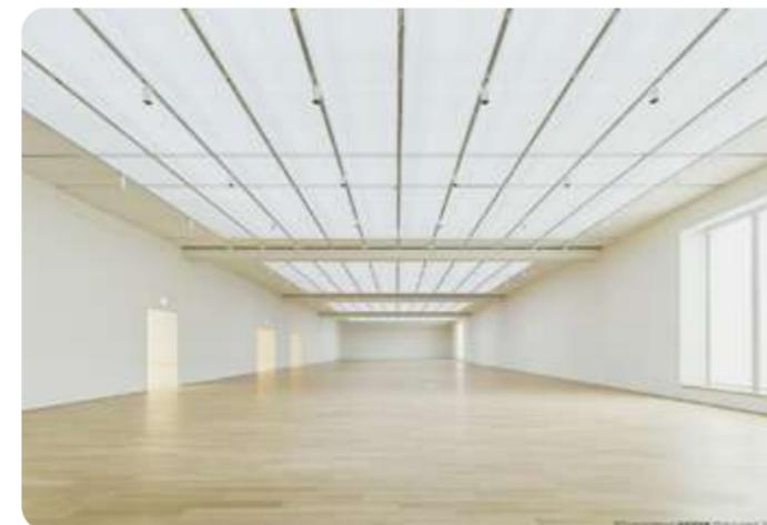
施工過程專注於永續材料應用與節能技術。使用高效透光紗增強天窗自然光導入，搭配紫外線過濾與遮光捲簾，達成節能減碳目標，同時滿足展示需求並符合永續建築標準
